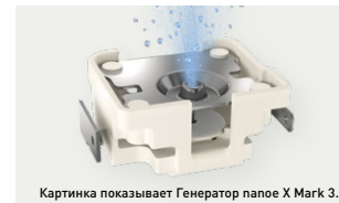
4 | Не требует технической поддержки и обслуживания. nanoe™ X – это решение без системы фильтров, которое не требует обслуживания, поскольку его распылительный электрод в процессе генерации покрывается водой и изготовлен из титана.
